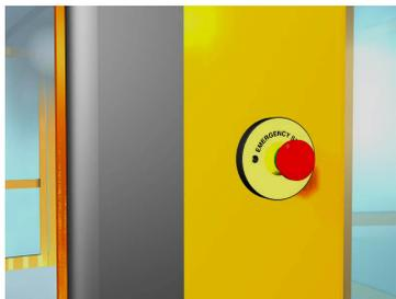
Em caso de emergência, a rotação da porta pode ser interrompida ao premir o botão de paragem de emergência. Para repor a porta para a rotação normal após a resolução da situação de emergência, [Secção Arranque após uma falha de alimentação, alarme de incêndio ou outros códigos de estado na página 26](#). A funcionalidade dos botões de paragem de emergência deve ser testada uma vez por ano.
