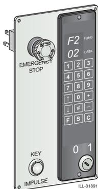
Sul pannello di controllo sono montati il PCD, un impulso a chiave e un pulsante di arresto di emergenza. L'impulso a chiave fa ruotare la porta di 360°. La distanza massima tra la porta ed il PCD è di 100 m.
